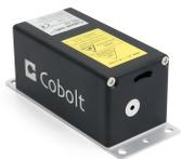
近年登場した、最も小型なレーザーです。主に150MHzまで変調可能な半導体レーザーがほとんどですが、532nm, 553nm 561nm のkHzレベルの変調可能な固体レーザーもあります。ファイバーピグテイルタイプもございます。
