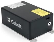
強励起を必要とする固体レーザーのため、最も大きなサイズとなります。その分04シリーズよりも高い出力で発振可能な他、320nmや355nmレーザー光など、他のシリーズでは得られない波長を発振することができます。
